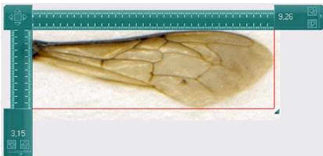
Рис. 3. Измерение длины и ширины крыла мониторной линейкой «mySize»
